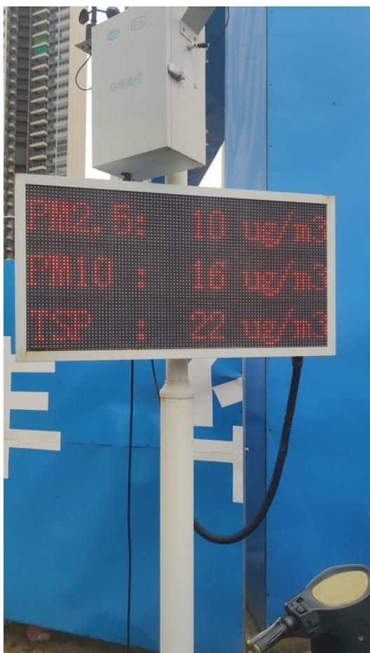
感器监测系统，可以实现对建筑工程的实时监测和数据采集。具体包括以下方面：第一，传感器监测：安装传感器设备用于监测施工现场的各项参数，如温度、湿度、压力等。这些传感器能够将收集到的数据实时传输到中央监控系统，以便进行分析和决策。德威江誉诚项目采用的就是扬尘检测仪，其结构简单紧凑，可以与远程监控中心以无线或者有线的方式通讯连接，在不需要现场工作人员值班的情况下就可以完成全部监控任务，降低了工人劳动强度；系统在超范围运行时会自动警告，提示工作人员及时做好防护措施以免对环境造成污染。第二，施工过程监测：通过摄像头和图像识别技术，实时监测施工过程中的关键节点和工艺环节。例如，在混凝土浇筑过程中，可以使用摄像头监测浇筑质量和流动性，并及时发现异常情况。
